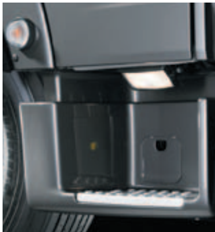
Маневровое освещение со стороны входа для второго водителя.
