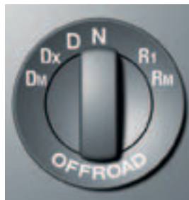
Селектор режимов MAN HydroDrive® для бездорожья.
